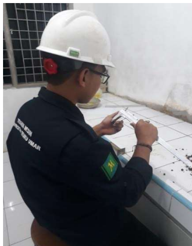
Gambar 3.1 Proses Pengukuran Diameter Biji
