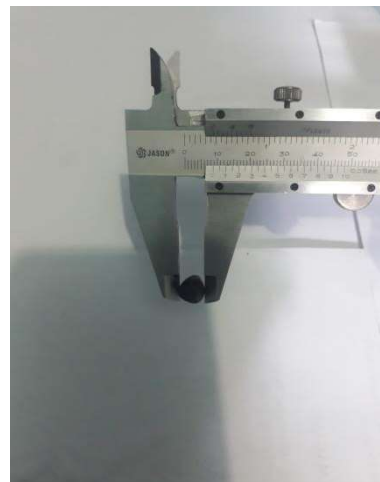
Gambar 3.1 Proses Pengukuran Diameter Biji
