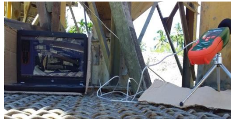
Gambar 3.3 proses pengukuran kebisingan mesin Jaw Crusher Sumber: (penelitian 2021)
